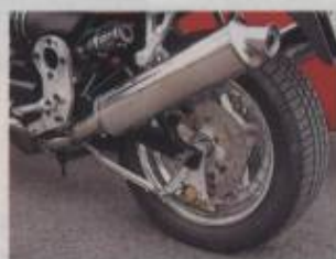
Aus eigener Produktion: aus dem vollen gefrästeten dreiteiligen Alurad und Ankerplatte für die Brembo-Scheibenbremse.
