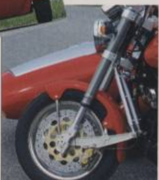
Zum Einsteigen wird die Scheibe samt Rahmen vorgeklappt (o.). Die Gabel klemmt in Spezialbrücken, die Bremsattel sind momentneutral abgestützt, der Nachlauf läßt sich per Exzenter verstellen (u.).
