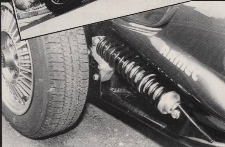
Das Seitenrad (von Fiat) ist von einer Kurzschwinge geführt und über einen Kniehebel gefedert
