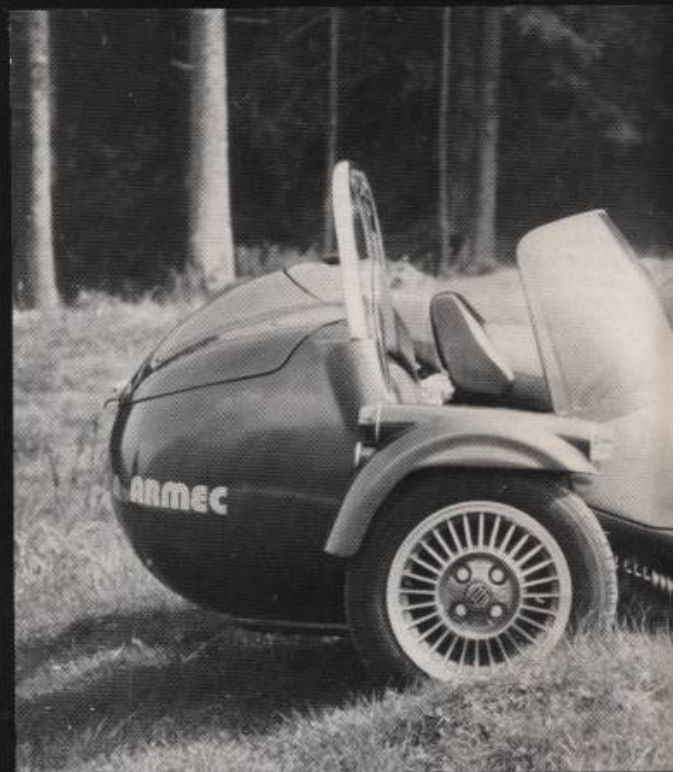
Die genial getroffene Form des Armec-Tremola Seitenwagens erinnert an die Rennwagen der 50er-Jahre. Die Areggers haben sie kombiniert mit so modernen Elementen wie Alugussrad, Überschlagbügel und Hai-fisch-Spoiler
