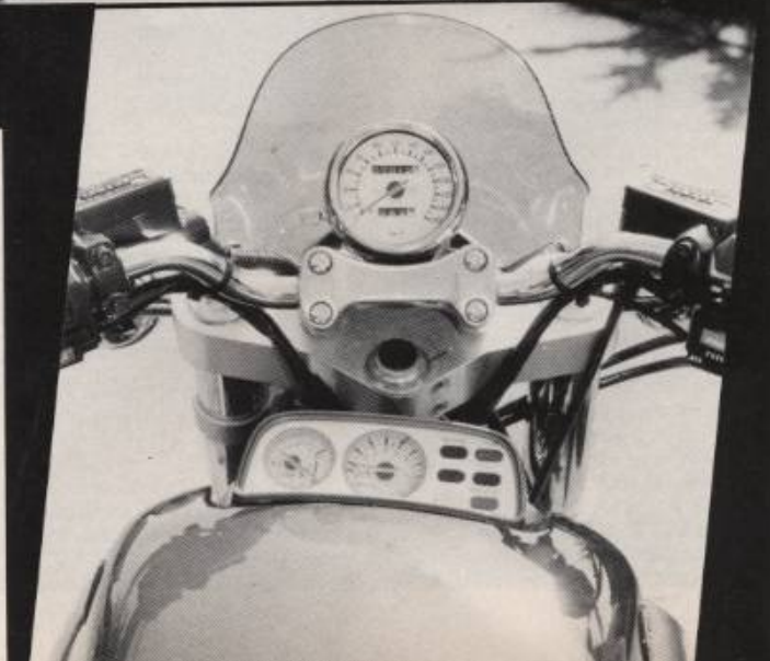
Rechts: Selbst die massiven Alu-Gabelbrillen fertigen die Areggers selbst an
