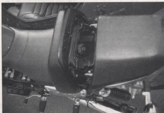
Vorn im Boot sitzt ein Ölkühler, der beim Testgespann noch nicht angeschlossen war. Lieferbar sind dafür zwei verschiedene rostfreie Blenden.
