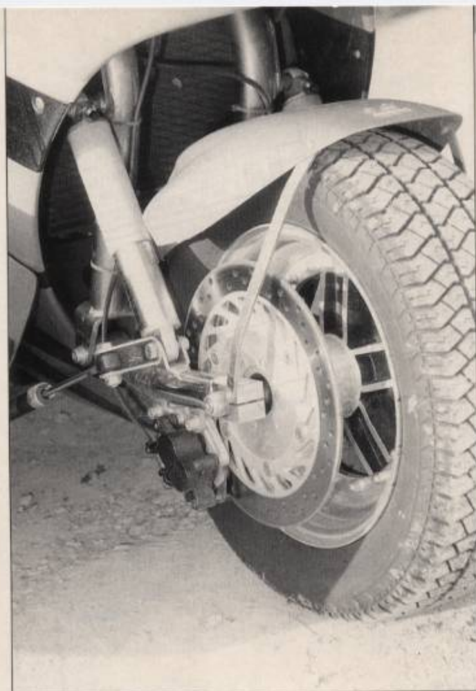
Die Beringer-Schwinge ist nicht gegen die Armec-Gabel austauschbar
