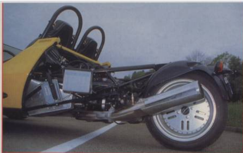
Motor, Auspuffanlage, Kardantrieb und Hinterradbremse stammen komplett von der BMW K 1100
